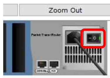
Nakon što nestane zeleni indikator rada uređaj je spreman za dodavanje novih interfacea. Dodajemo 3 interfacea vrste „PT-ROUTER-NM-1CGE“ u slotove počevši od desne strane. Nakon dodavanja trebali bi dobiti sljedeće:
